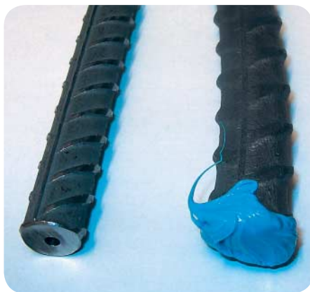
Fig. 2 Rebars of steel grade UNS S32101 (EN 1.4162) prior tests.
